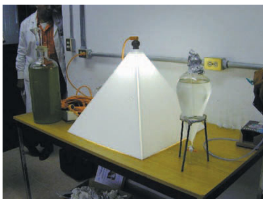
Figura 3.6. Cámara casera para las pruebas con algas.
